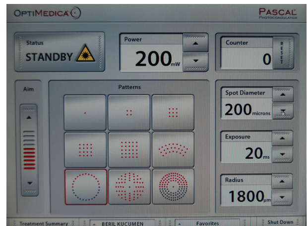
Resim 1: PASCAL retina fotokoagülatörünün kontrol panelinde patern seçeneklerinin gösterildiği ana menu görülmektedir.
