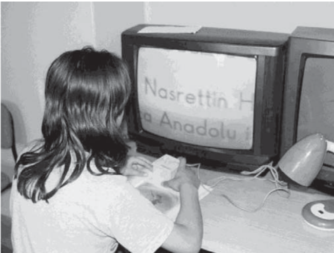
Resim 8: Elektro-optik büyütme sistemi örneği; okunan metin bir kamera aracılığı ile ekrana büyütülerek aktarılıyor.
